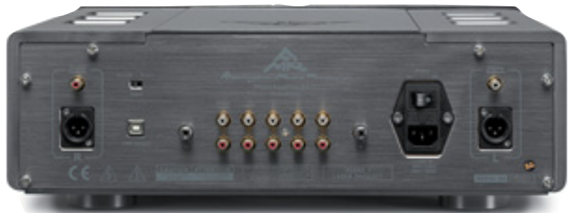
USB? USB! Der PH-77 reicht das Phosignal via A/D-Wandler an den PC heraus
