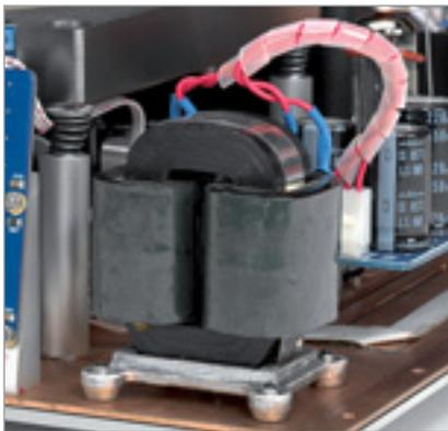
Siebspulen für das aufwendige Netzteil der Röhren-Ausgangsstufe
