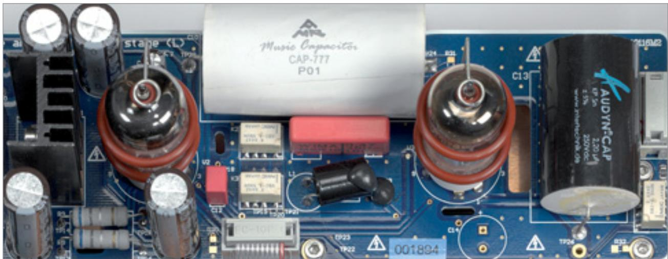
Serienmäßig wird der Player mit NOS-Röhren geliefert, die unter Halteklammern sitzen und mikrofoniedämpfend mit Gummiringen versehen sind
